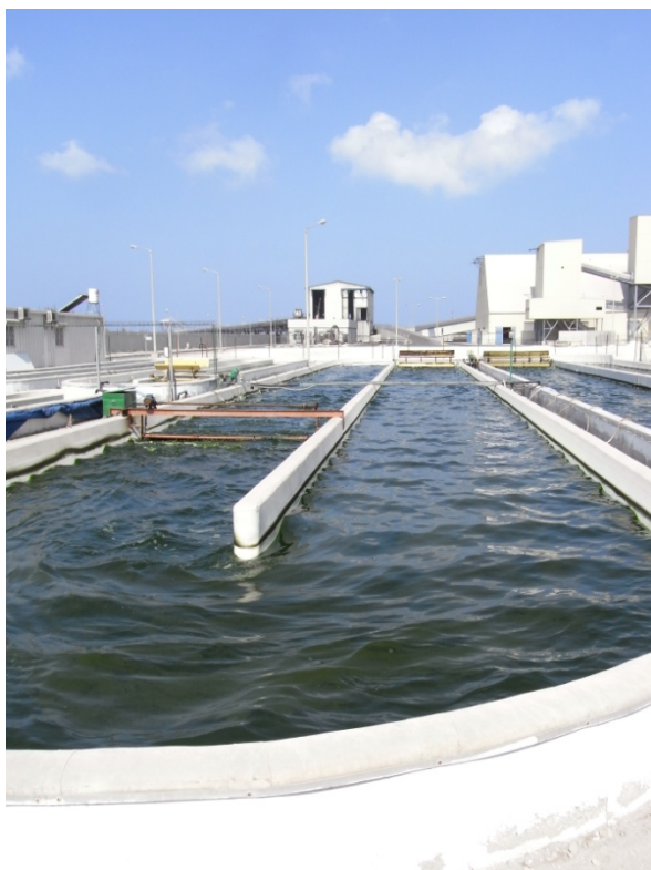
Figur 6. Åbne algedamme (“raceway ponds”) ved Seambiotics forsøgsproduktionsanlæg ved Ashkelon, Israel. Eget fot.
